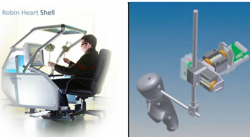
Rys. 5 Konsola RobInHeart Shell (po lewej); model nowego zadajnika ruchu ramienia (po prawej)[15]
