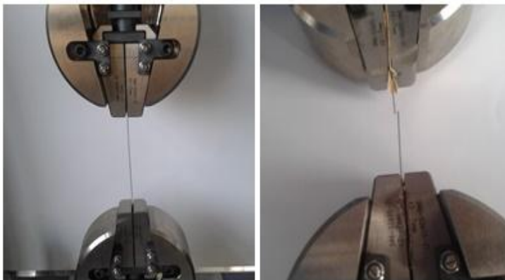
Rysunek 3. Drut umieszczony w maszynie wytrzymałościowej przed i po zerwaniu. Źródło: opracowanie własne
