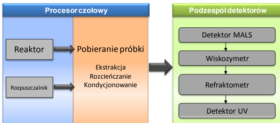
Rysunek 8. Uproszczony schemat systemu ACOMP (opracowanie własne na podstawie [3])
